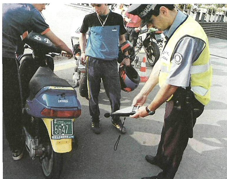
Un agent practica una sonometria a un ciclomotor
