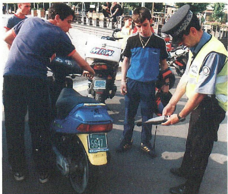
El sonómetro registra el índice acústico de los vehículos
